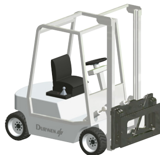
Schnellwechsellvorrichtung, Grundrahmen zum Einhängen auf Original Gabelträger des Gabelstaplers
