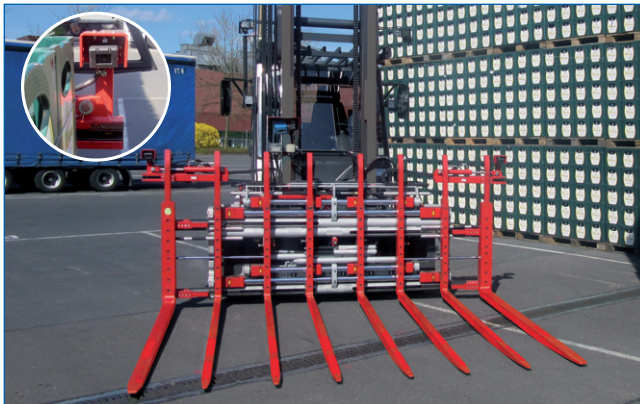
Bild zeigt Typ APK 80-C in Sonderausstattung mit ausfahrbarer Kamera
