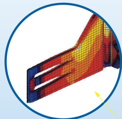
Ballenklammer mit computergestützten FEM-Berechnungen optimiert
